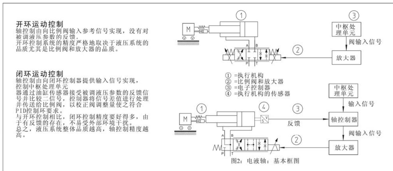
Atos比例阀可以用在开环状态（阀不带传感器）也可用在闭环状态（阀带LVDT位置传感器或压力传感器），见图1。不带传感器的比例阀通过放大器向线圈输入与参考信号成比例的电流驱动。为确保最优性能，放大器应该由阀制造商提供。
