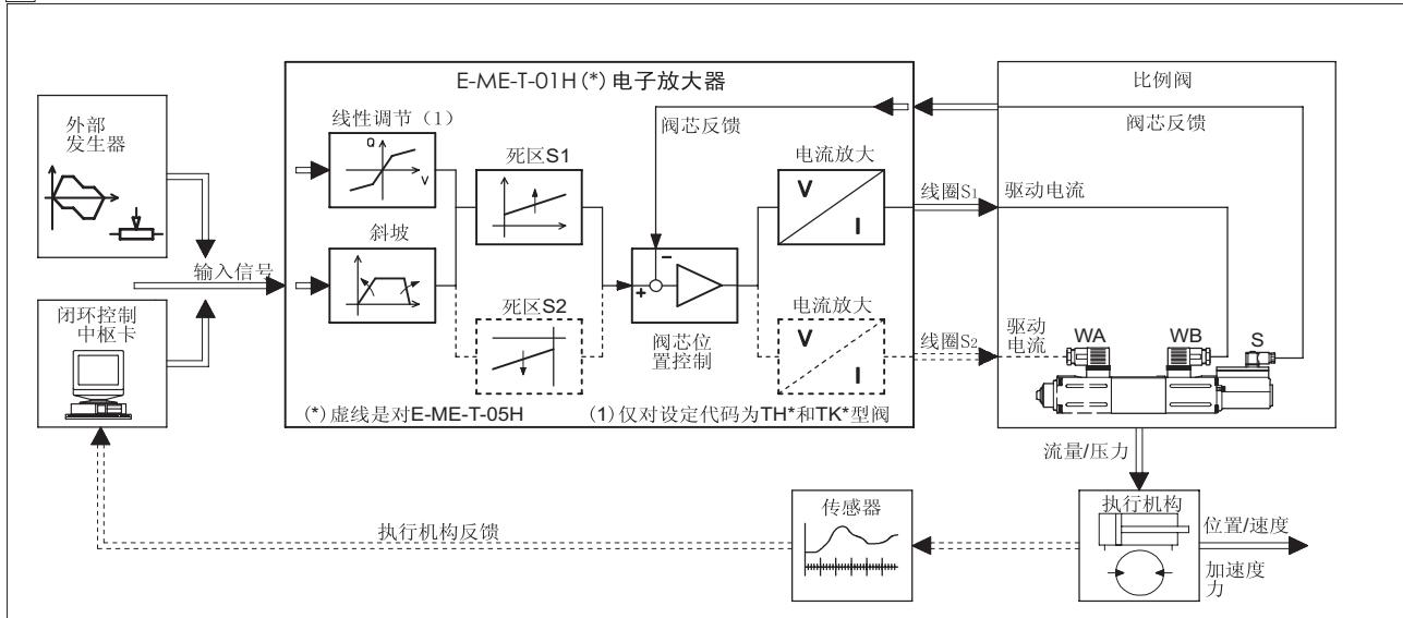
**E-ME-T型电子放大器**用于驱动Atos带位置传感器型比例阀，根据输入参考信号大小以及反馈信号，调整对比例电磁阀提供的电流信号的大小，以调节阀芯位置和流量。
