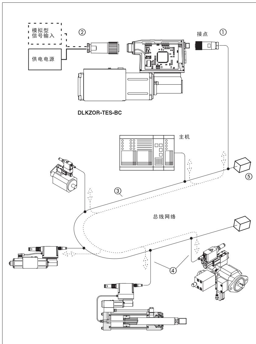
集成数字式放大器的Atos比例阀和比例泵，可选总线通讯接口①-BC型和-BP型。
